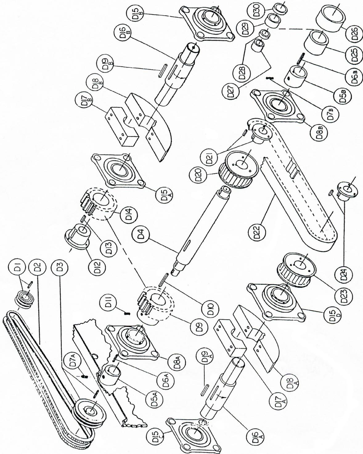
DRIVE ASSEMBLY FIGURE 2 GILSO-MATIC GX-4, GX-5
